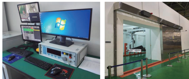
图 3 FDR-160X 数字射线自动成像检测系统 (来自中航复材及其团队)
